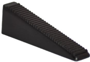
La cuña Peygran se ajusta en el calzo de sistema de nivelación con nuestro alicate especial. Sus dientes en forma de sierra permiten que esta se encaje con el calzo de forma efectiva, no soltándose durante el fraguado. La base de la misma está totalmente redondeada, lo cual evita que se dañe el porcelánico al retirar el sistema. Disponible en 100 uds, 300 uds y 500 uds.
